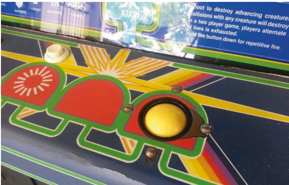
Abb. 8.1 Control-Panel des Arcade-Spiels Centipede (1980, Atari/Atari), bestehend aus Feuer-Button sowie Trackball
